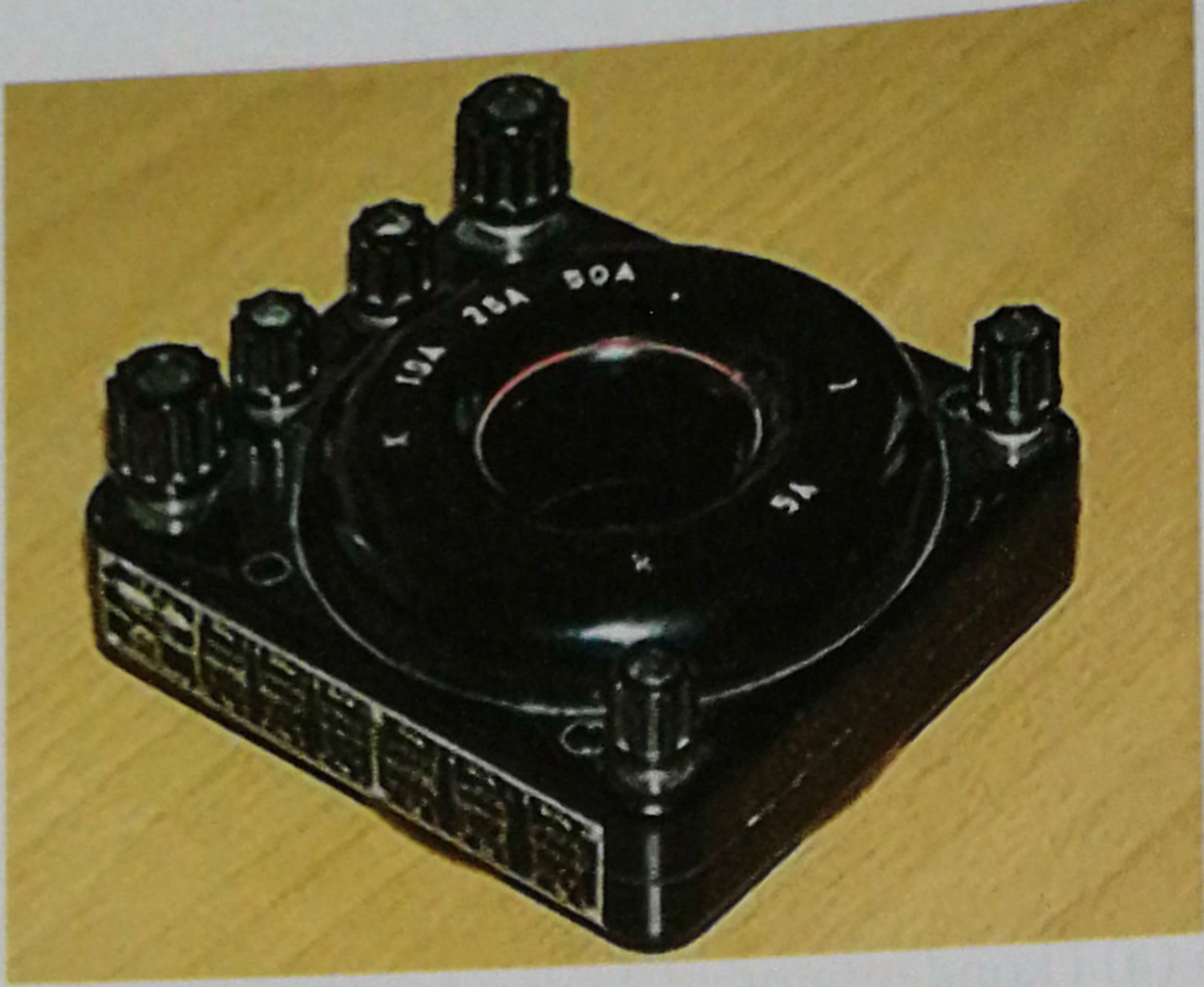
Rys. 2.25 | Widok laboratoryjnego przekładnika prądowego o regulowanej przekładni
